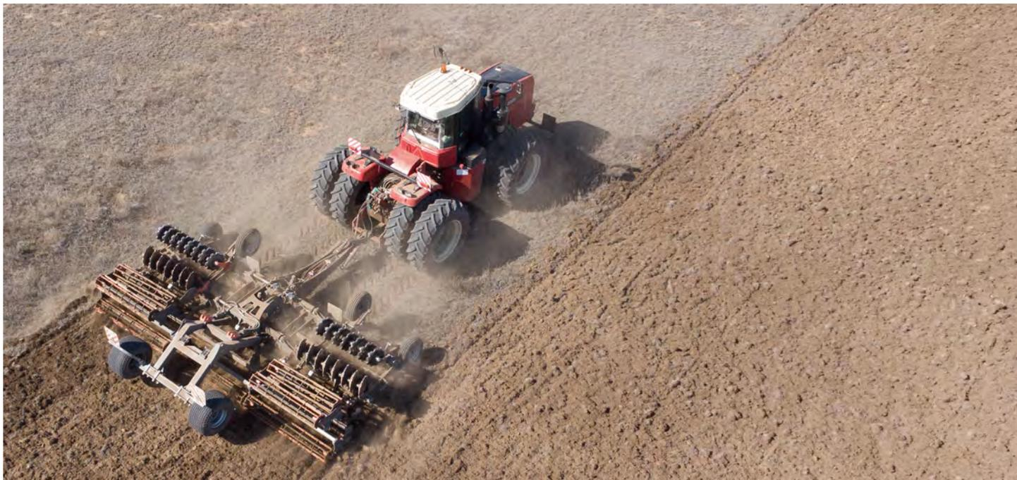
При работе на сухих и твердых почвах сложите крайние секции БД-11. Это даст возможность догрузить средние рабочие секции и улучшить врезание режущих дисков в твердую пересушенную почву.
