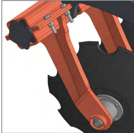
■ Каждая стойка с диском крепится к раме индивидуально. В месте крепления стойки рабочего органа к раме установлены резиновые амортизаторы (демпферы), которые воспринимают и смягчают ударные нагрузки при контакте диска с препятствиями, предотвращая поломку рабочего органа.
