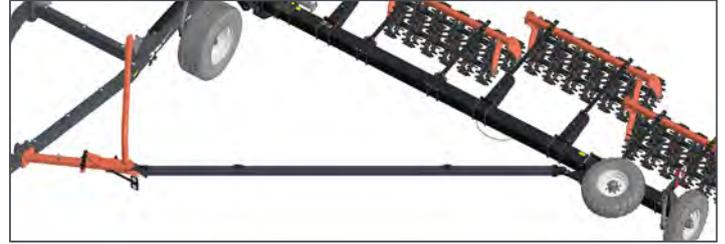
■ Жёсткая растяжка (штанга) позволяет без дополнительных механизмов при необходимости сдать назад, в отличие от тросовых конструкций.
