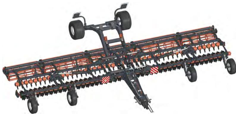
Дисковая борона БД-7 может быть переоборудована в БД-11 путём установки дополнительных секций.
