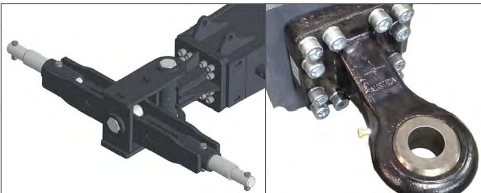
■ Борона оборудована сцепной петлёй под палец 50 мм, в качестве опции может быть установлен поперечный брус Cat 4, что даёт возможность агрегатирования с различными типами тракторов.
