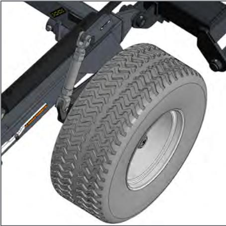
■ Широкие колёса на сцепке (базе) позволяют эксплуатировать орудие на мягких грунтах.
