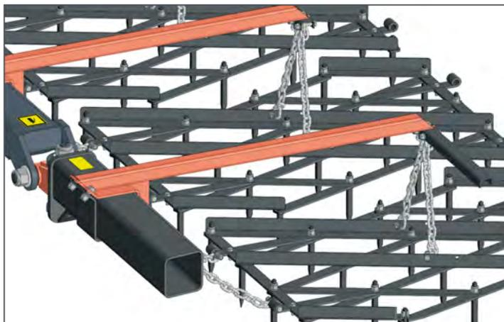
■ Рама изготовлена из профиля квадратного сечения (150x150x8 мм), сталь марки 09Г2С.
