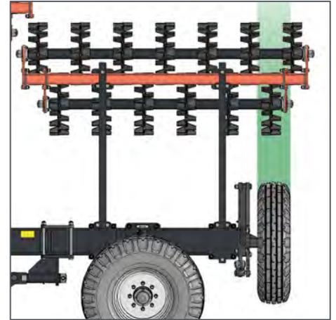
■ Отсутствие следа от крайних колёс позволяет получить равномерно обработанное поле.
